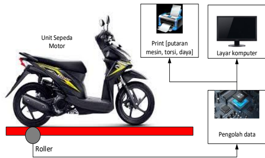
Gambar 5. Skema pengujian unjuk kerja sepeda motor dengan alat uji dynotest
