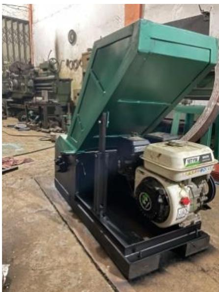
Gambar 5. Mesin pencacah multifungsi
