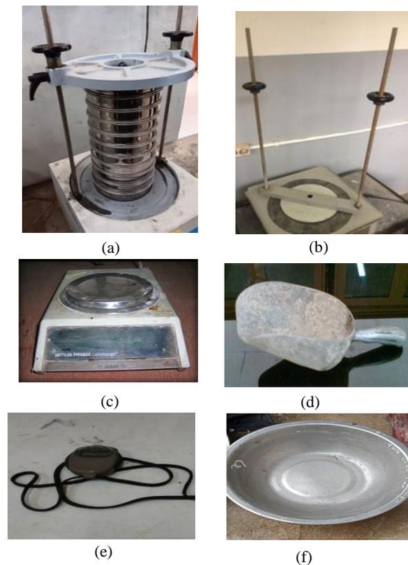
Gambar 2. (a) 1 set ayakan, (b) vibrator/ mesin getar, (c) timbangan digital, (d) sendok material, (e) stopwatch dan (f) cawan
