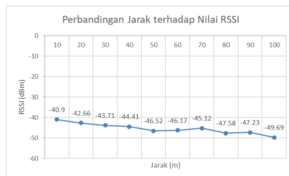
Gambar 7 Bagan Perbandingan RSSI terhadap Jarak
