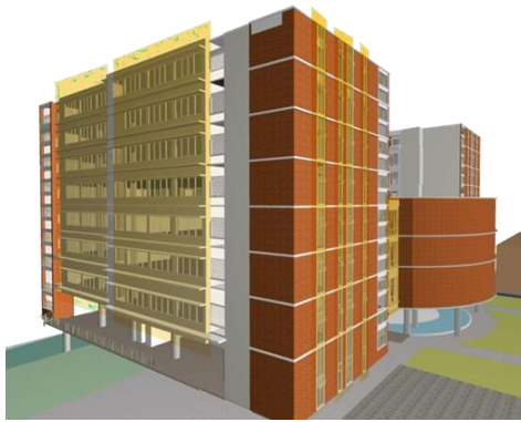
Gambar 8. Ilustrasi pengaplikasian kaca sunergy clear (SNFL) di PUSGIWA UI
