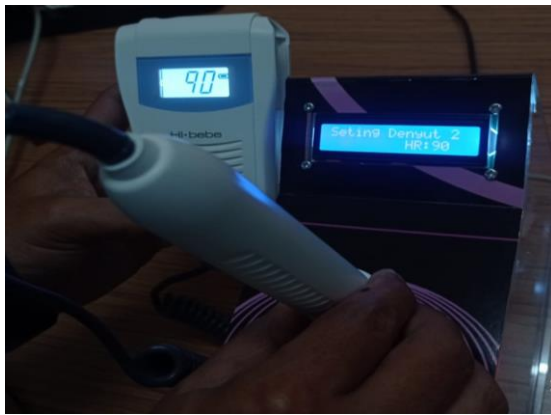
Gambar 5. Pengujian simulator dengan setting 90 BPM
