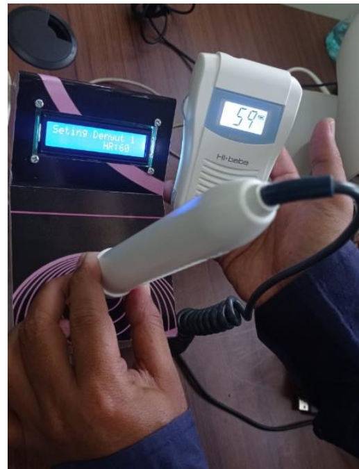
Gambar 4. Pengujian simulator dengan setting 60 BPM
