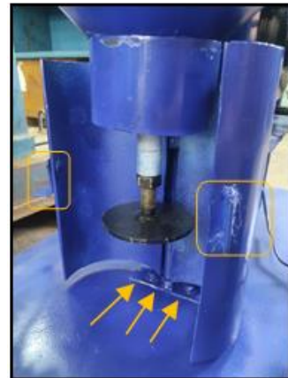
Gambar. 9 Adjustment plat penekan dan pintu tabung yang terbuka dua sisi
