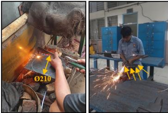
Gambar. 6 Pematangan Plat Dudukan Magnet clutch menggunakan laser (kiri), dan proses abrasi untuk sudut tepi yang kasar menggunakan gerinda
