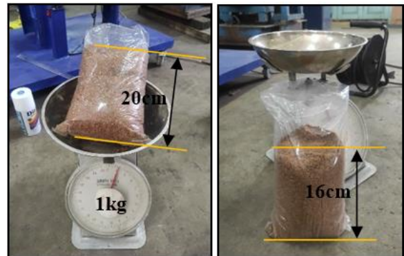
Gambar. 15 Hasil uji coba dengan ketinggian plat penekan 3.5cm dengan ketinggian awal 20cm dan berat 1kg
