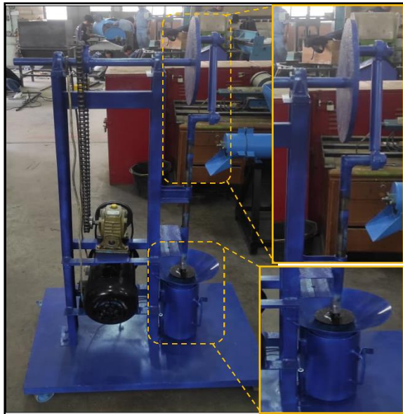
Gambar. 13 Modifikasi aktual mesin press baglog jamur tiram menggunakan sistem magnet clutch
