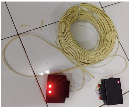
Gambar 6. Proses pengukuran kabel panjang 100 meter
