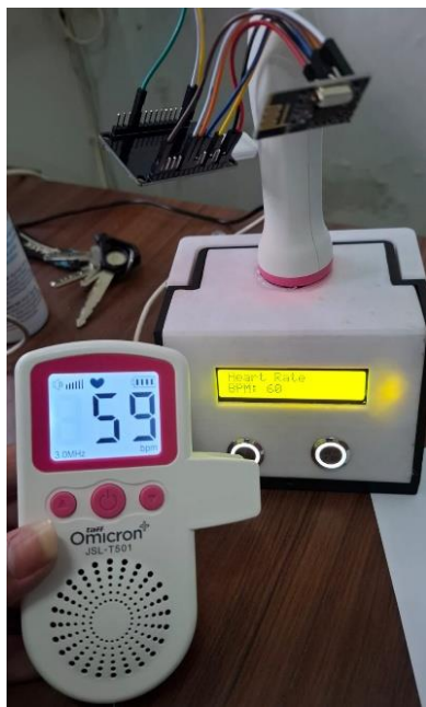
Gambar 6. Uji prototype dengan simulator fetal doppler
