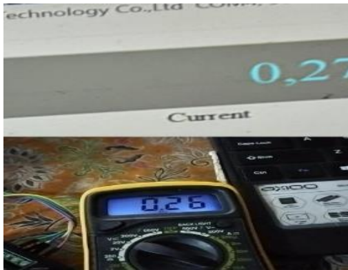
Gambar 4 Kalibrasi sensor arus
