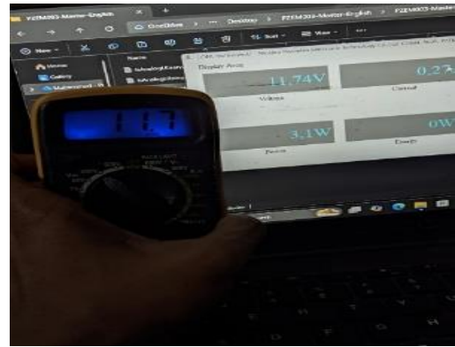
Gambar 3. Kalibrasi sensor tegangan
