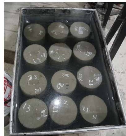
Gambar 11. Perawatan benda uji silinder beton
