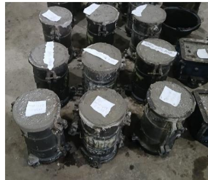
Gambar 10. Benda uji beton berbentuk silinder
