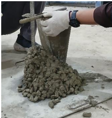
Gambar 9. Pengujian slump pada beton segar
