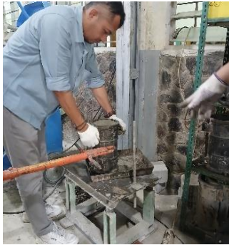
Gambar 8. pematatan benda uji dengan vibrator
